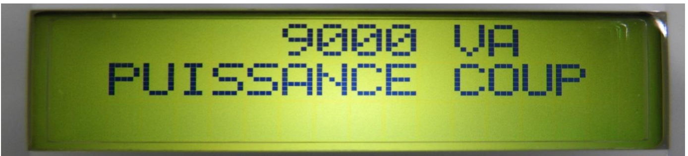
Affichage exemple : 9000 VA soit 9 kVA PUISSANCE COUP = PUISSANCE COUPURE NETTE DISJONCTEUR INTÉGRÉ AU LINKY
